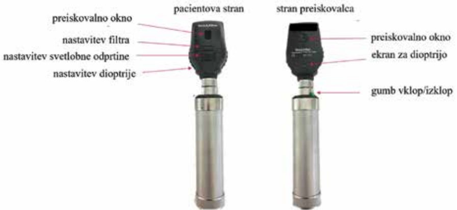
Slika 26: Osnovni deli oftalmoskopa. (Avtor slik: M.A.V.)
